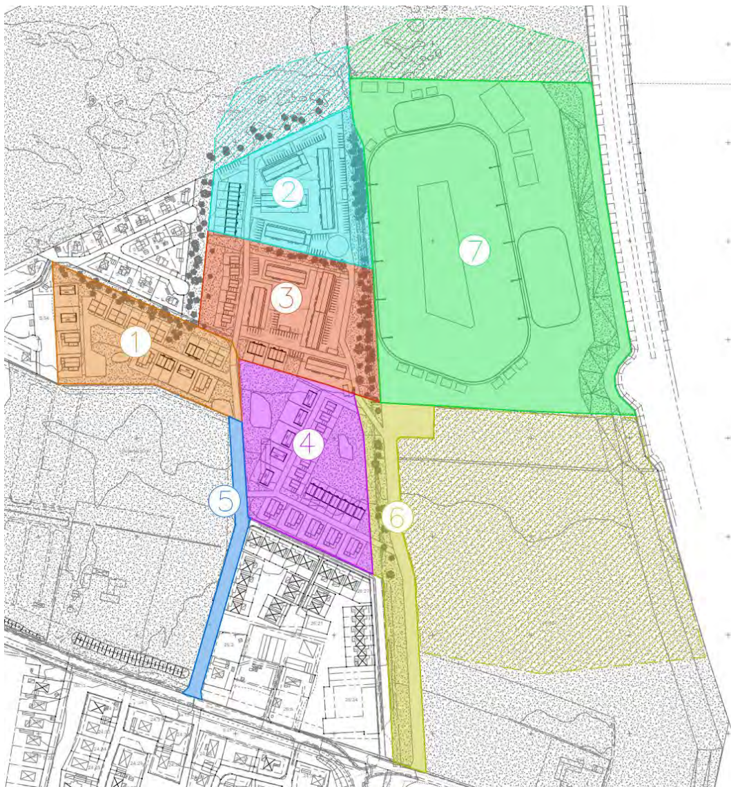
Figur 5. Översikt över sju olika delområden. De skrafferade ytorna redovisar tillkommande ytor som bidrar med dagvattenflöden till delområdena.
