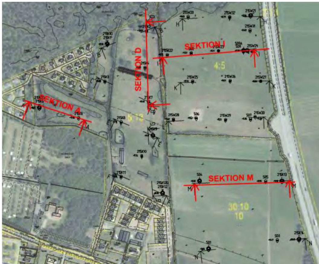
Figur 3. Flygfoto med utförda geotekniska undersökningspunkter samt tolkade sektioners läge i plan.
