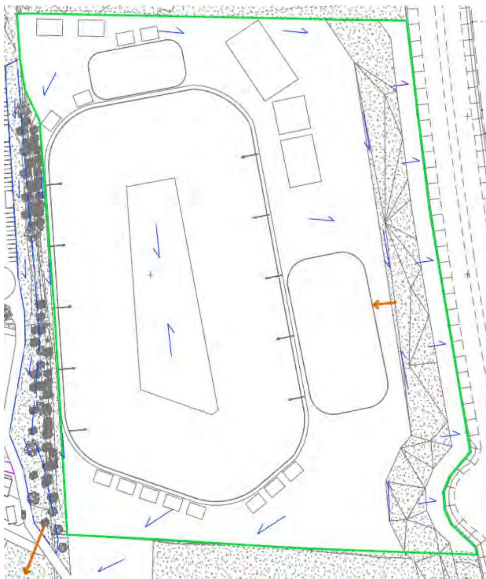
Figur 21. Förslag på dagvattenavledning inom delområde 7, se blå pilar. Orange pilar redovisar tänkta skyfallsstråk (se avsnitt 6).
