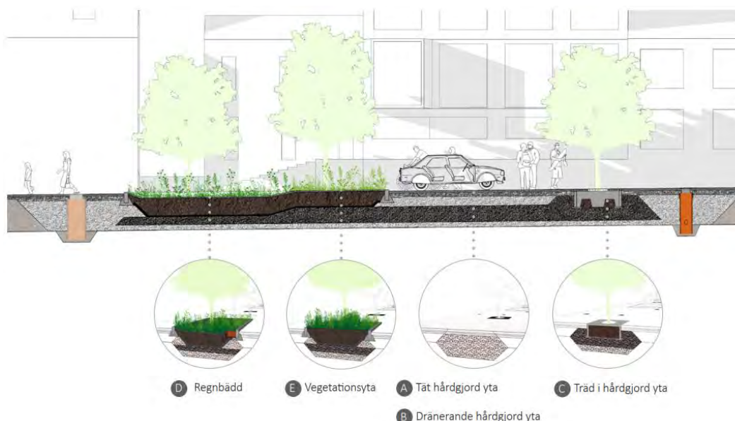
Figur 8. Principiell utformning av makadambäddar i olika utföranden i gatumiljö (Edge, 2019).
