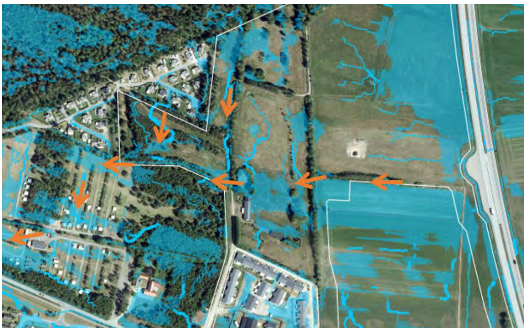
Figur 24. Befintliga flödesvägar vid skyfall (orange pilar).
