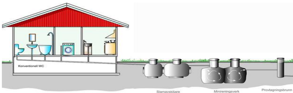
Bild: Principskiss för minireningsverk ( www.avloppsguiden.se )
