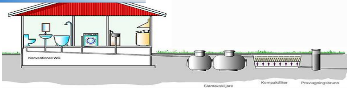
Bild: Principskiss för kompaktfilter eller biomoduler ( www.avloppsguiden.se )
